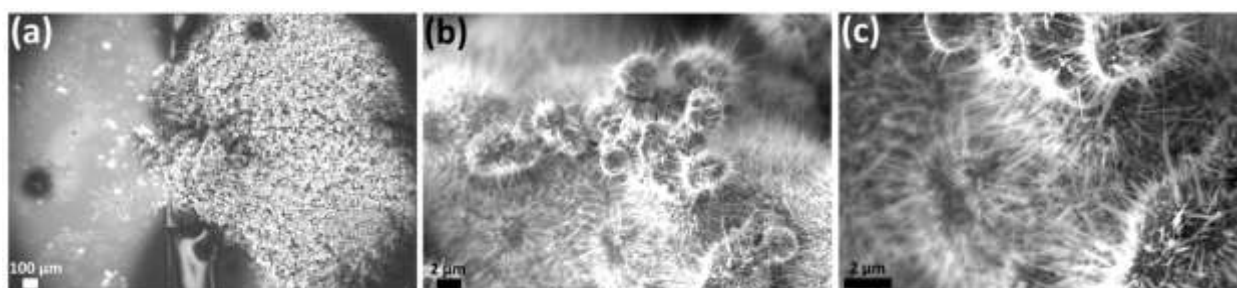
Figura 3.11 Imaginile SEM a rețelelor de nanofire de CuO-FeO (raportul de 1:1, mărimea particulelor de fier 10 \mu\text{m} ) tratate termic la 425 ^{\circ}\text{C} timp de 4 ore cu rata de creștere a temperaturii de \sim 3.4 ^{\circ}\text{C}/\text{min} : a) mărime joasă; b) mărime medie și c) mărime înaltă.
