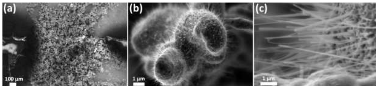
Figura 3.8. Imaginile SEM a rețelelor de nanofire de CuO tratate termic la 425 °C timp de 4 ore cu rata de creștere a temperaturii de ~40 °C/min: a) mărire joasă; b) mărire medie si c) mărire înaltă.
